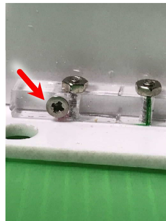
電池ボックスを取り付けた 側板と天板を固定するビス 天板には、UNO とコントロールシールド 基板をのせる
