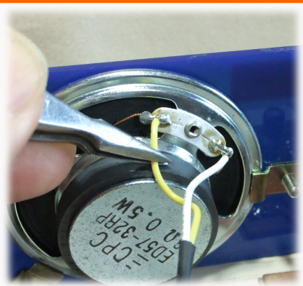
作業⑧ スピーカーの配線
